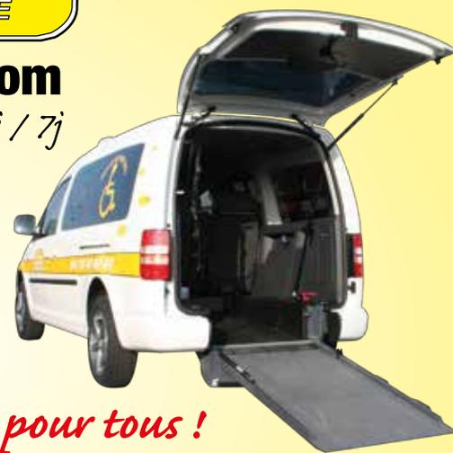
Véhicule équipé pour un fauteuil roulant électrique ou manuel
