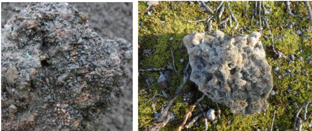
Figure 29 : Fraisat à gauche (enrobé concassé) et conglomérat de galets roulés induré (griffe) à droite
