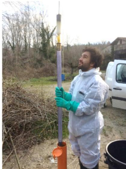
Figure 40 : Dispositif de prélèvement de phase organique manuel au tube préleveur jetable à gauche, et au moyen d'un écémateur passif oléophile à droite
