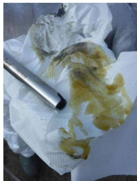
Film jaune visqueux en G9 non prélevable manuellement ni avec un écrémeur passif
