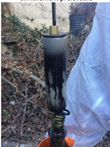
Phase flottante en G6 très visqueuse et non prélevable avec un écrémeur passif
