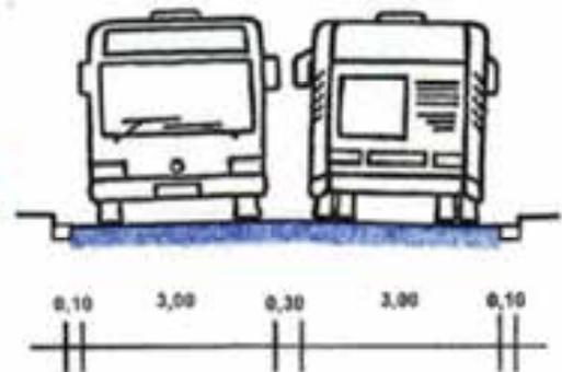
Principes de dimension standard d'une voie bidirectionnelle
